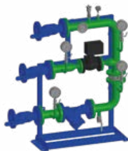
Модуль ГВС для открытой системы теплоснабжения с регулирующим клапаном и линией циркуляции ГВС
